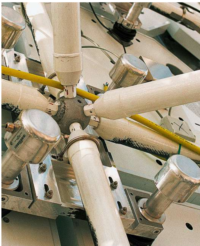
Jede der «Magic» Trägerplatten wird von zwei Kugelgewindetrieben justiert.
